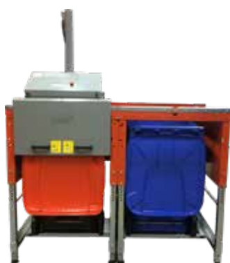
Pressenheten skyves enkelt fra det ene til det andre kammeret.
