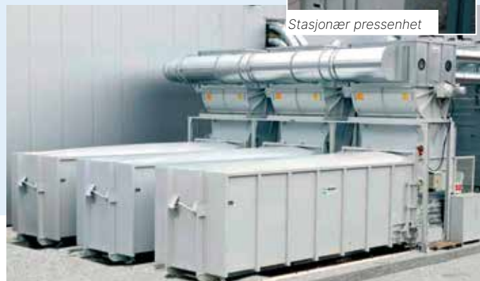
Containere i kombinasjon med stasjonære pressenheter og tilkobling til sjakt.
