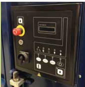
Modell E-08 er utstyrt med et oversiktlig kontrollpanel som bl.a. varsler når pressen er full og når det er tid for service.
