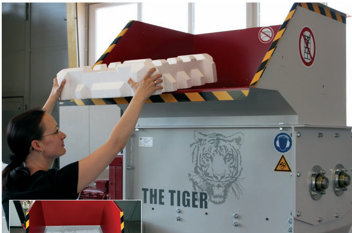
En effektiv forknuser med to-tanns roterende aksler
