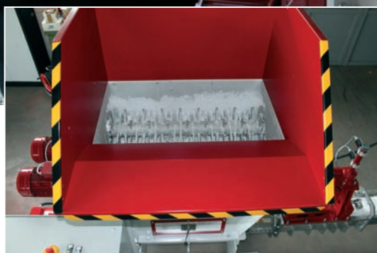
En effektiv forknuser med to-tanns roterende aksler
