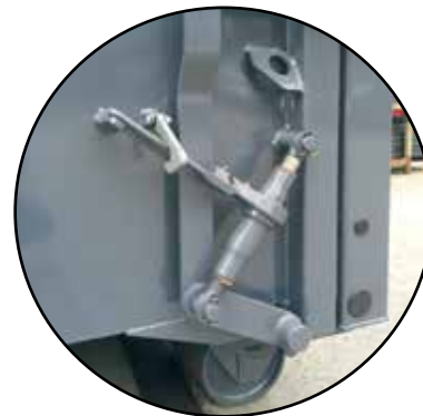
Låsemekanismen til tømmedør er standard utstyrt med tre solide låseklaver. Kan om ønskelig også leveres med 4 låseklaver.
