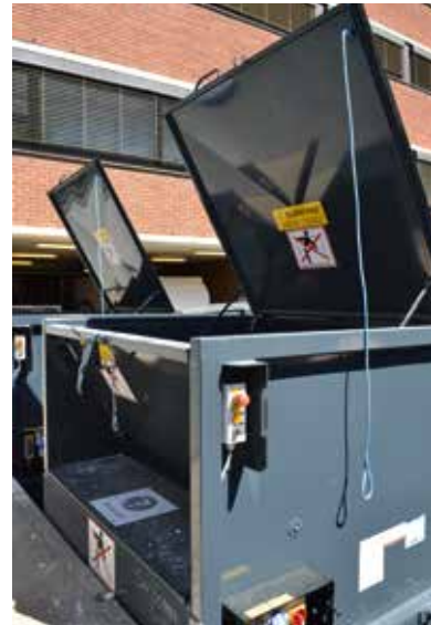
Liftkomprimator vist med rampeløsning og 80° lokk med tau.
