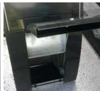
Innkasthusets serviceluke er utstyrt med stag for å holde luken åpen.
