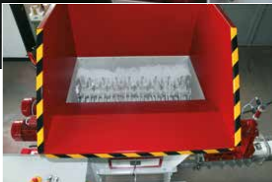
En effektiv forknuser med to-tanns roterende aksler
