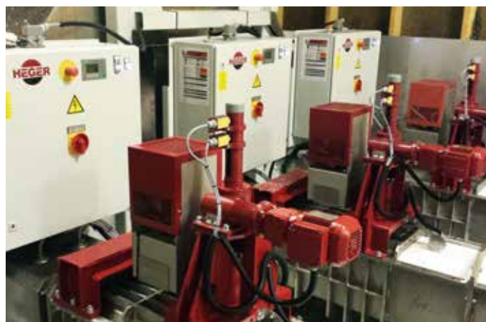
Norsk Sjømat AS har 3 stk. Heger Tiger 400 for komprimering av isopor. Komprimeringsgraden er 40:1
