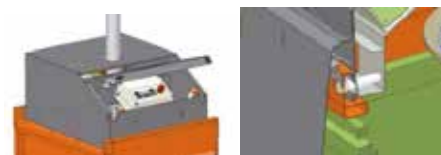
Fullt beskyttet mot beveglige deler. Sikkerhetsbryter på toppluke og på skyveskjørt.
