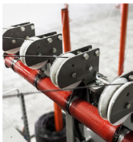
Overvåking av ledningsbrudd som kontrollerer bindingen av stålwirene.
