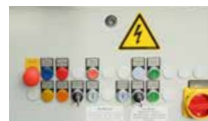
Felles kontrollpanel for løftevender og avfallskomprimator
