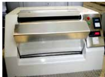
Trapp gir enkel tilgang til innkastet på komprimatoren. Veieenheten er separat, kan demonteres og flyttes over i en annen komprimator.
