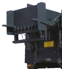
KAM-holder. Alternativ ID-registrering hvor ID-avleser registrerer ID direkte fra beholder.
