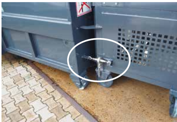
Mobil løftevender låses enkelt fast i komprimatoren.
