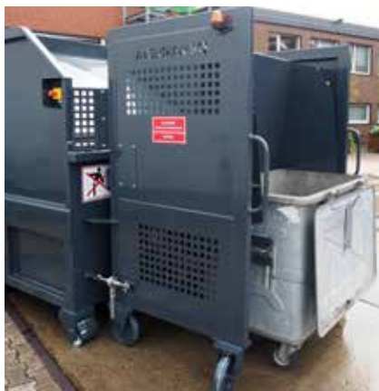
Mobil løftevender låses enkelt fast i komprimatoren.
