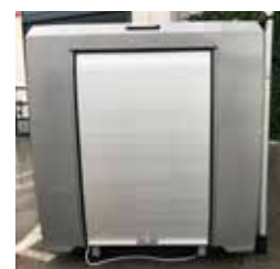
Bak sjalusidøren skjuler det seg en løftekrok. Hele komprimatoren er innkapslet.
